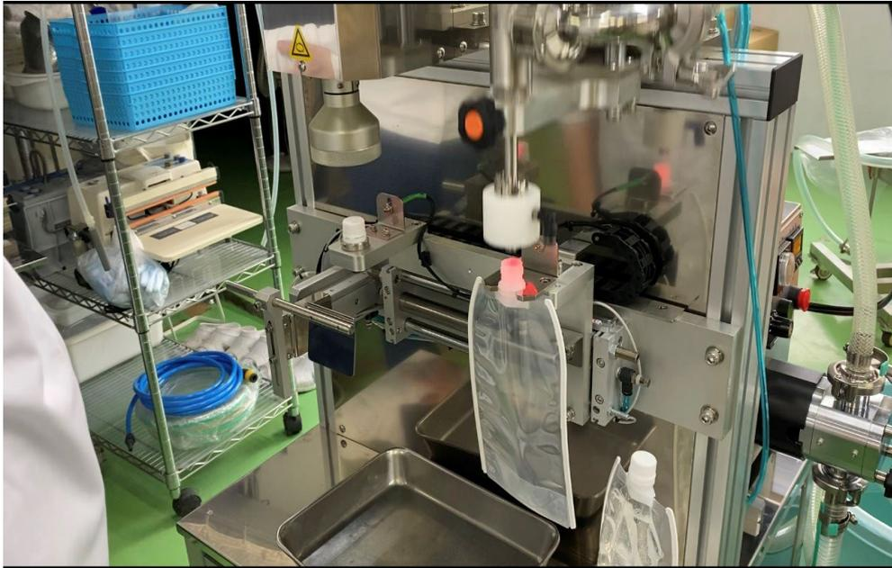
充填・脱気・キャッピングを1人作業で生産出来ます。
